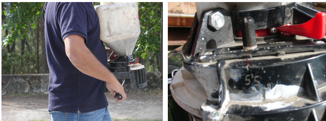
Figura 2. Detalle de abonadora en pruebas de calibración. Se puede apreciar el selector de apertura (palanca roja) y a su izquierda el dosificador (pivote negro)
